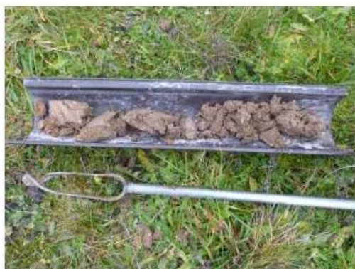
Figure 8 : profil de sol du sondage S4
