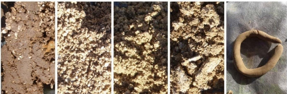
5. Examen du sol sur l'ensemble de la carotte prélevée : couleur, texture, structure. droite, test de plasticité : pouvant former un boudin refermable en un cercle, le substrat présente 20 à 30% d'argil
