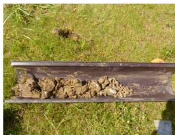
Figure 7 : Profil de sol sondage 2
