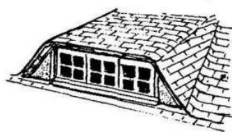
lucarne en trapèze (couv. bardeaux d'asphalte)
