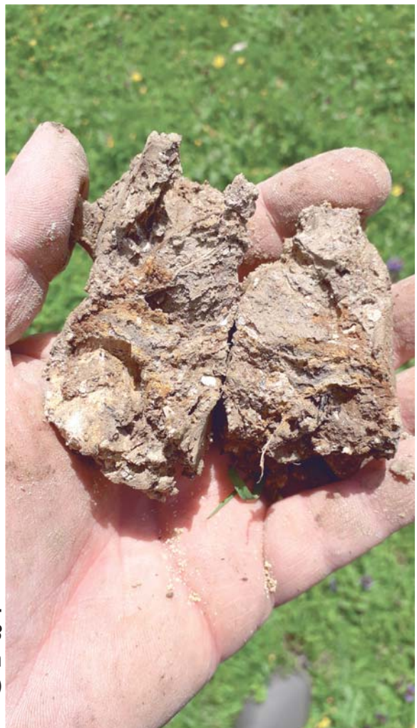
Sondage n° 24 horizon 3 40-55 cm (taches rouille 15 %)
