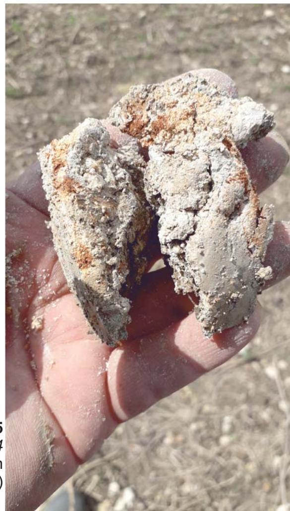
Sondage n° 7 horizon 3 60-70 cm (taches rouille 10 %)
