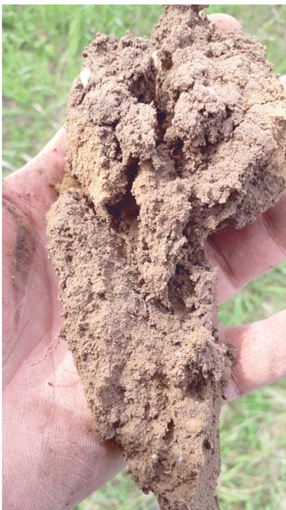
Sondage n° 7 horizon 3 60-70 cm (taches rouille 10 %)
