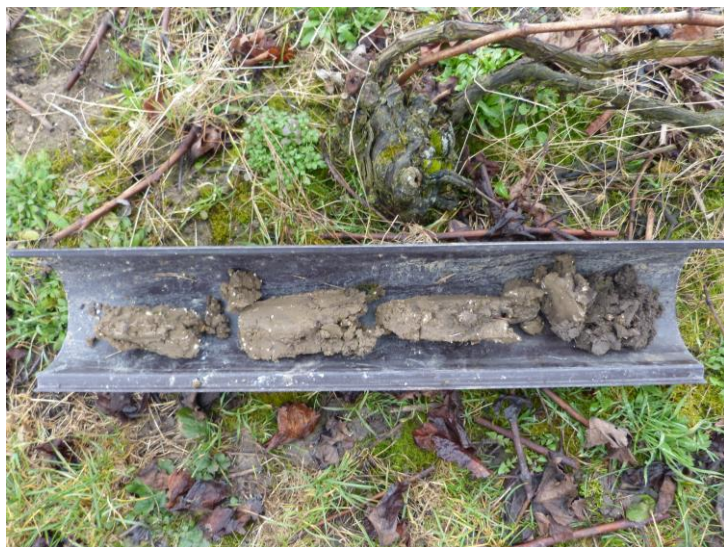
Figure 5 : profil de sol du sondage
