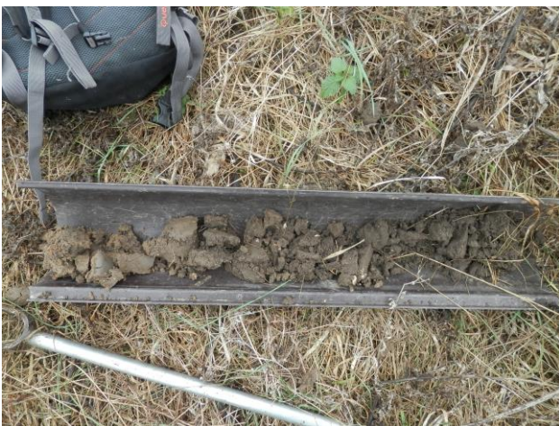
Figure 7 : profil de sol du sondage 4 (non humide)
