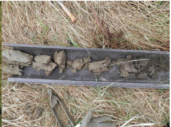
Figure 6 : profil de sol du sondage 2 (humide)
