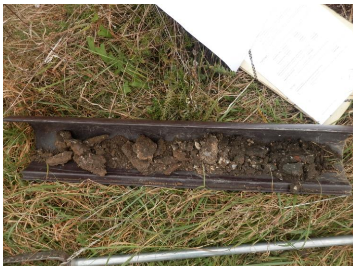
Figure 7 : profil de sol du sondage 2
