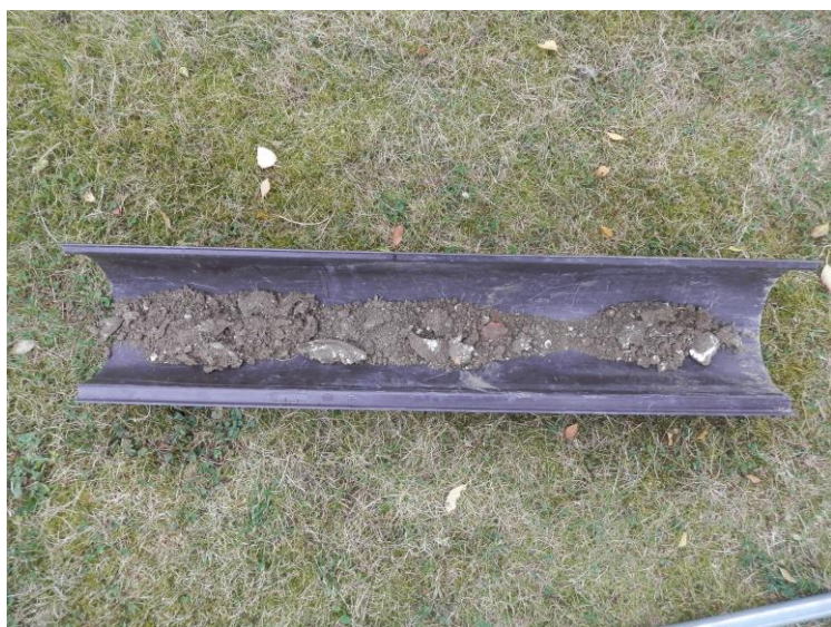
Figure 5 : profil de sol du sondage
