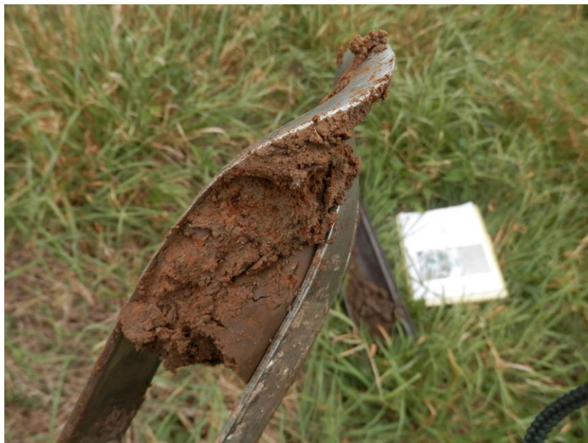
Figure 7 : traces d'hydromorphie visibles sur le sondage 2
