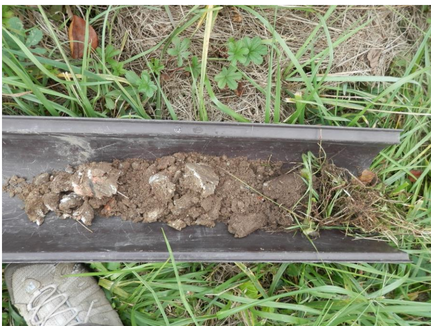
Figure 5 : profil de sol du sondage
