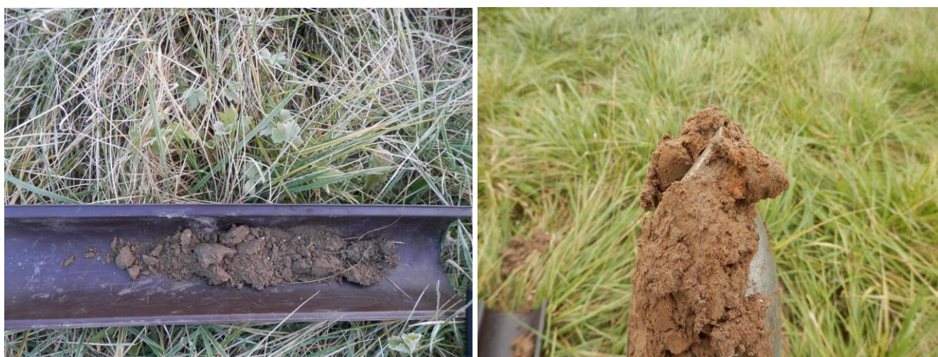
Figure 5 : profil de sol du sondage (terre brune riche en matière organique en surface puis sol argileux avec traces d'hydromorphie)
