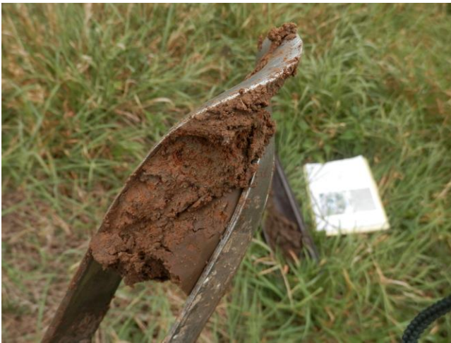
Figure 5 : traces d'hydromorphie visibles (sondage 1)
