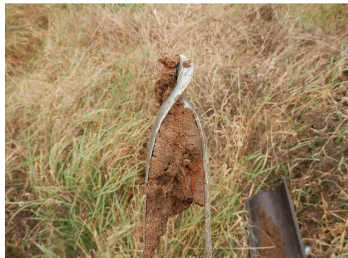
Figure 6 : profil de sol du sondage 1 sur la parcelle 680 (tâches de rouille nettement visibles).
