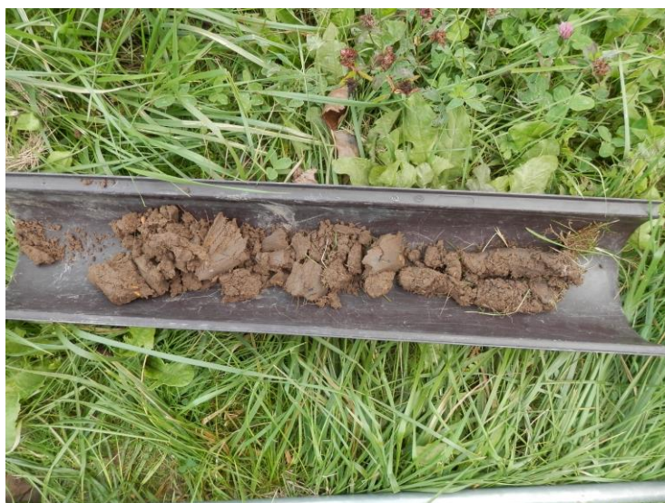
Figure 5 : profil de sol du sondage
