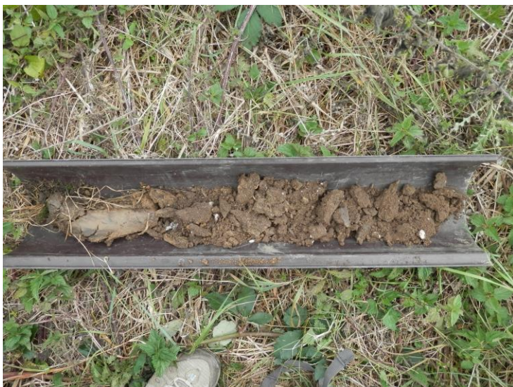
Figure 5 : profil de sol du sondage
