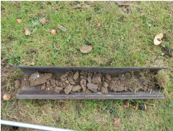
Figure 5 : profil de sol du sondage 1
