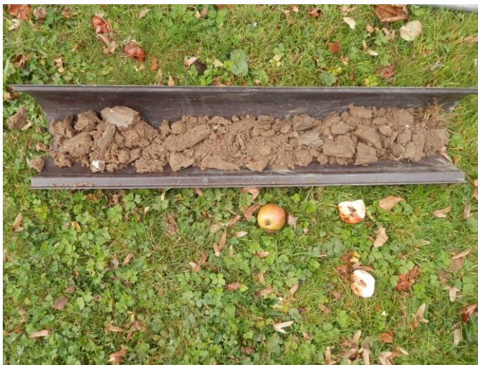
Figure 6 : profil de sol du sondage 2
