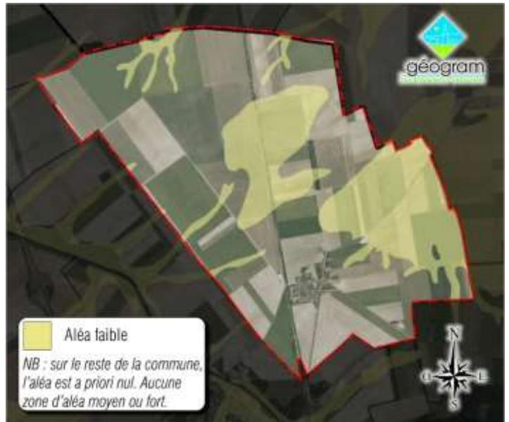
Figure 40 : Aléa de retrait/gonflement d'argiles
