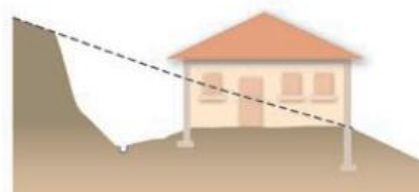
Plate-forme en déblais
