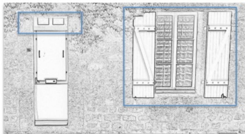
Porte avec imposte vitrée.
