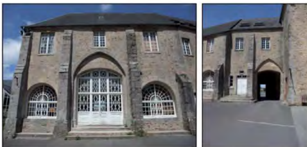
Photos n° 1 et 2, ancien corps de bâti en parti préservé. Présence d'une ancienne porte cochère ouverte sur la rue, contreforts sur les façades principales, et baies en anse de panier avec fenêtres aux petits meneaux détaillés.
