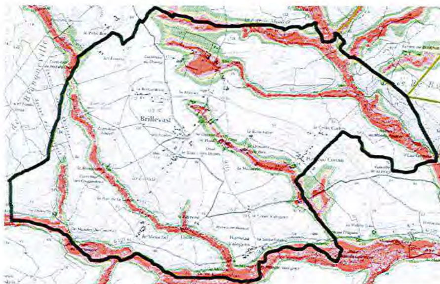
Extrait de l'atlas des zones non saturées (risque de remontées de nappes) (DREAL)
