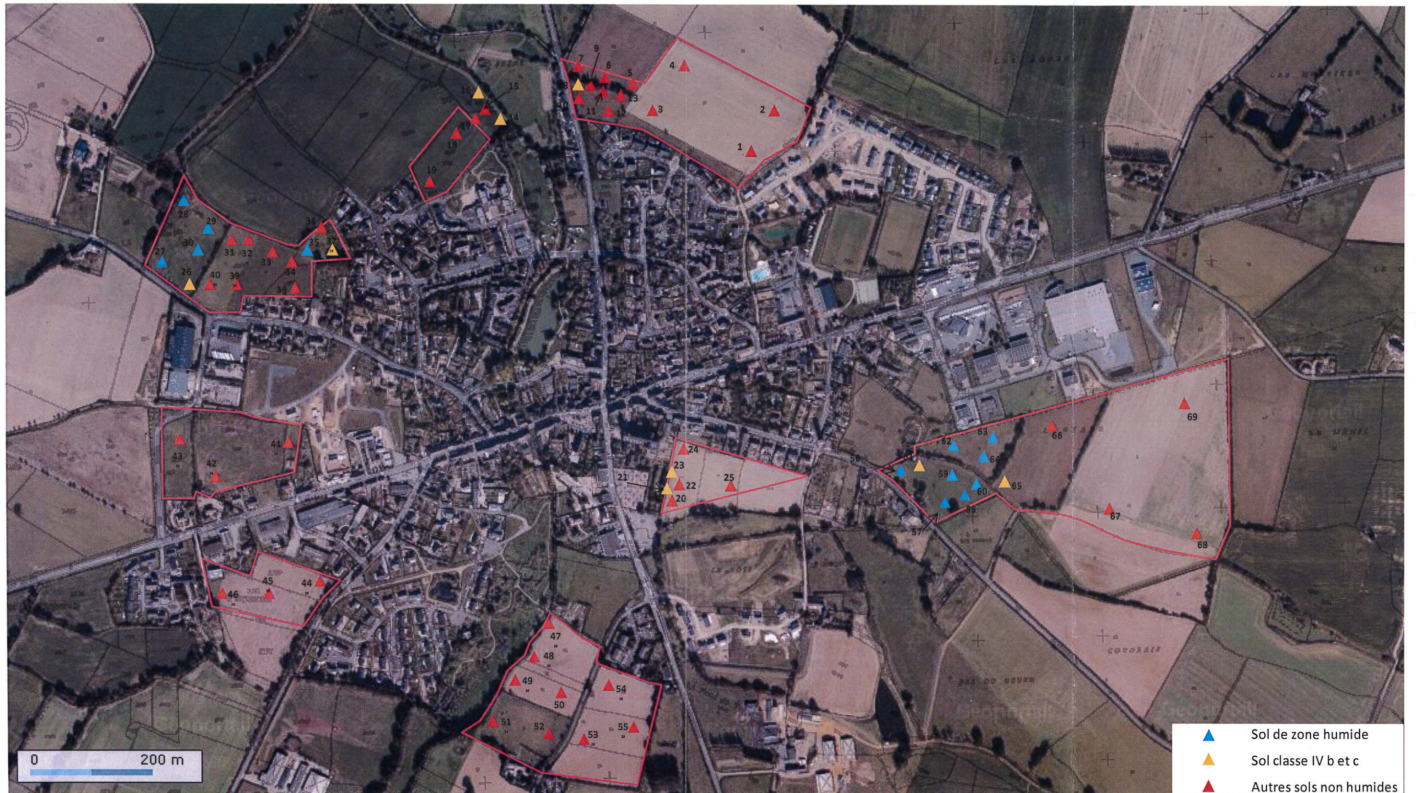
Carte N°7 : Localisation des sondages sur vue aérienne
