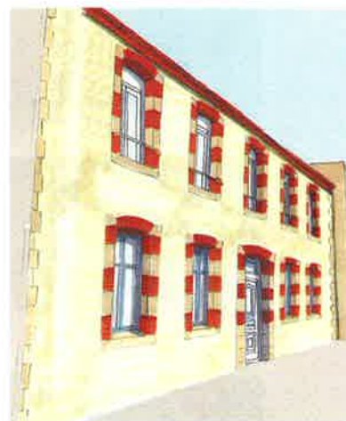
Remplacement de la porte et installation de garde-corps et de volets roulants au premier étage
