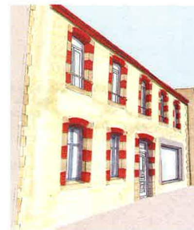
Remplacement de deux fenêtres par une baie vitrée
