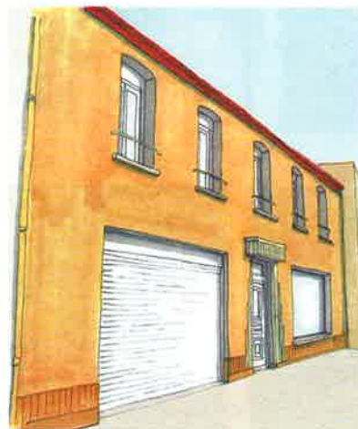
Suppression des encadrements de fenêtres avec un nouvel enduit
