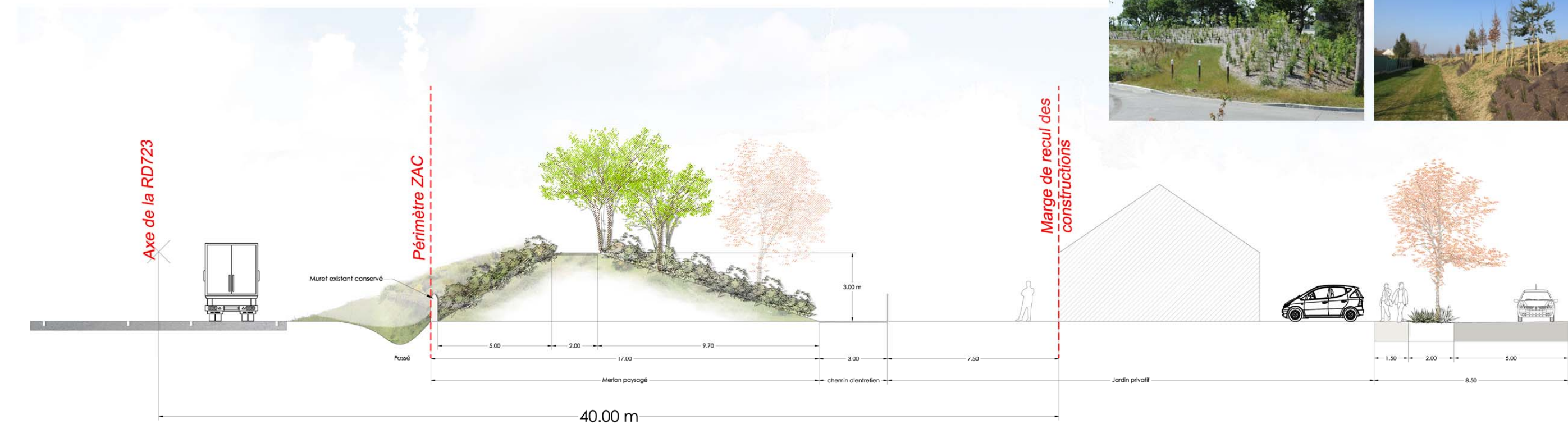
▲ Coupe de principe d'am nagement du merlon paysag 
