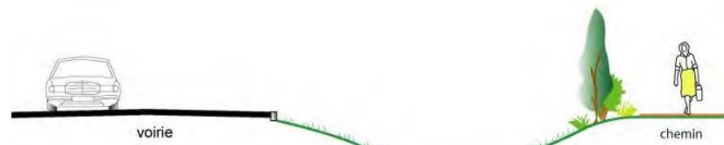
Noue en bordure de voie
