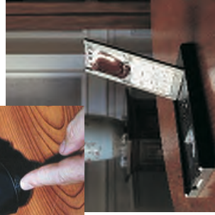
Exemples de dosimètres utilisés par l'IRSN pour les mesures dans les bâtiments.
