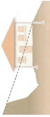
Plate-forme en déblais
