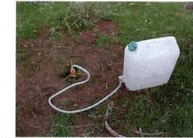
Test de perméabilité en place sur le site d'épandage
