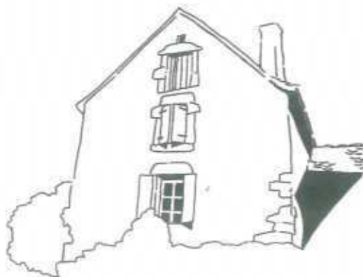
Ouvertures en pignon avec encadrements
