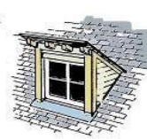
lucarne retroussée, ou demoiselle ; c'est aussi le vrai chien-assis
