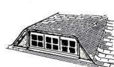
lucarne en trapèze ou rampante à jouées biaisées (couverture en bardeaux d'asphalte)
