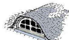
lucarne à jouées galbées (couverture ardoise ou chaume)
