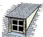
lucarne rampante ou en chien couché
