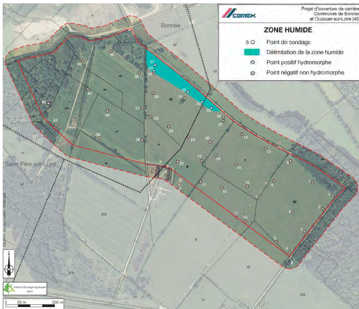
Figure 5 : Localisation des sondages pédologiques (source : IEA janvier 2015)
