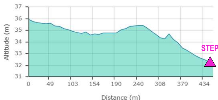
Figure 73 : Profil altimétrique du projet d'assainissement du secteur « La Raffinière » – Scenarior 2
