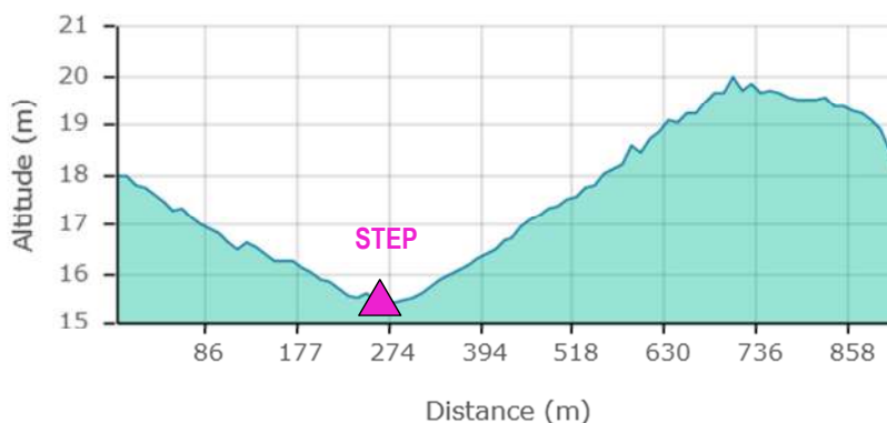
Figure 70 : Profil altimétrique du projet d'assainissement du secteur « La Chevallerais » – Scenario 3
