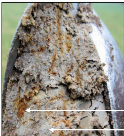
Photo 2: Mise en évidence de traces d'hydromorphie lors d'un sondage à la tarière
