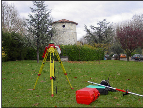
GPS utilisé pour les relevés topographiques
