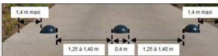
Ci-dessus : dispositif filtrant sur une voirie de largeur 5 m et plus
