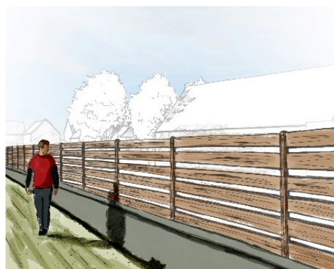
Mur surmonté d'un dispositif à claire voie
