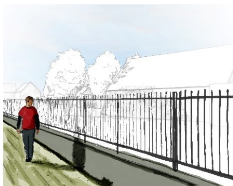
Mur bahut surmonté d'une ferronnerie
