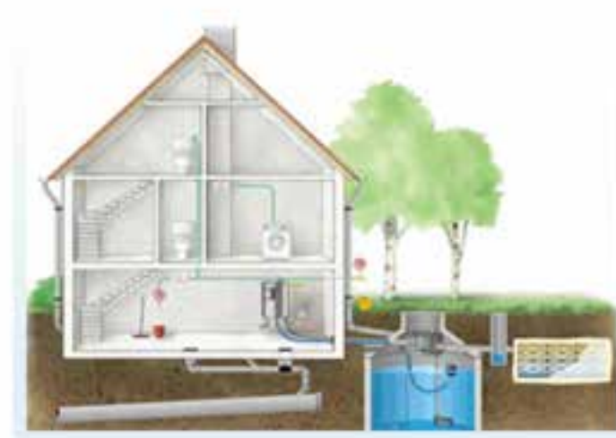
Système de récupération d'eau de pluie avec une injection dans un réseau spécifique pour les toilettes, la machine à laver et le jardin.
