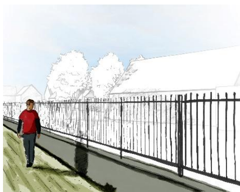
Mur bahut surmonté d'une ferronnerie
