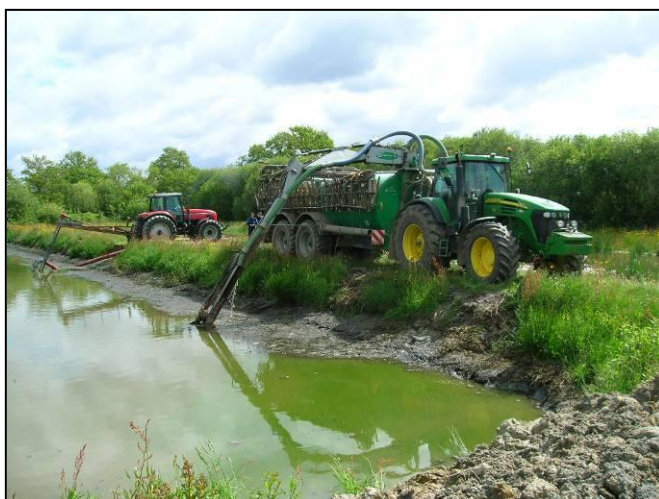
Pompage des eaux surnageantes
