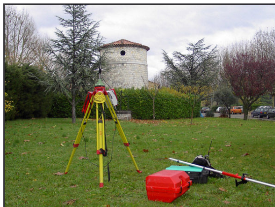
GPS utilisé pour les relevés topographiques
