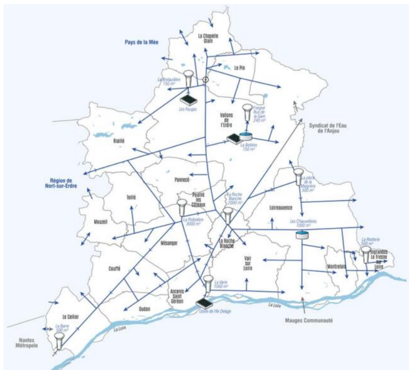
Schéma de l'alimentation en eau potable de la région d'Ancenis
