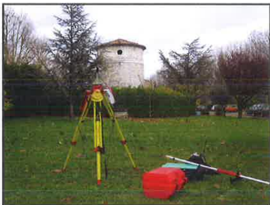
GPS utilisé pour les relevés topographiques
