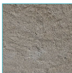
Enduit à la chaux
