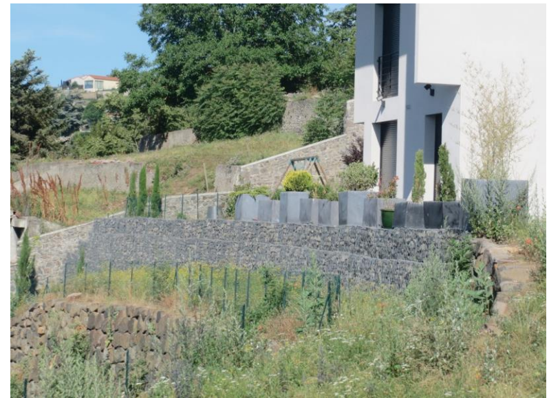
Réinterprétation contemporaine de la chambée en muret de gabion (Aiguilhe)
