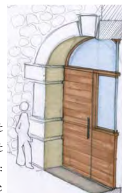
Exemple d'élément d'architecture ayant valeur de patrimoine : linteau cintré en pierre
