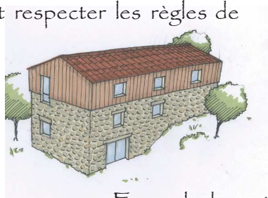
Exemple de surélévation
