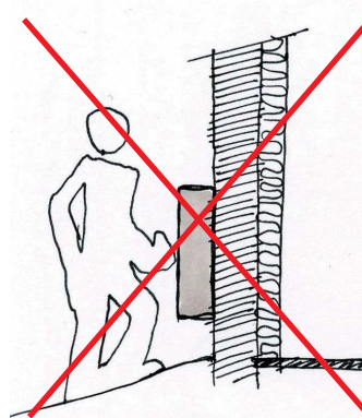
Élément non intégré à la façade
