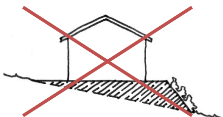
la mise à niveau par talutage
