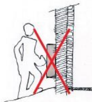
Élément non intégré à la façade
