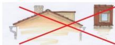
Exemples d'ouvertures non intégrées à la pente du toit
