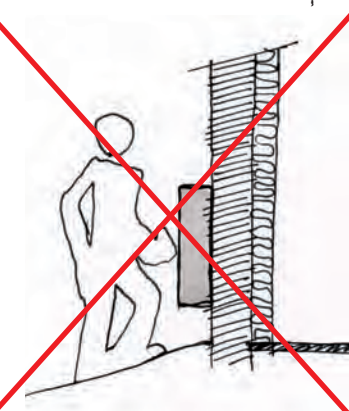
Élément non intégré à la façade
