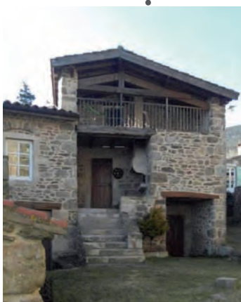
Exemple de débord de toiture
