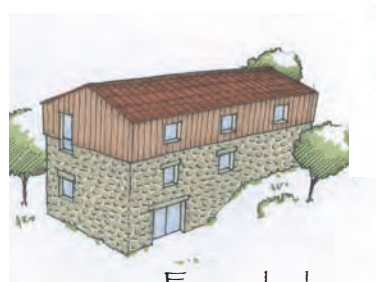
Exemple de surélévation
