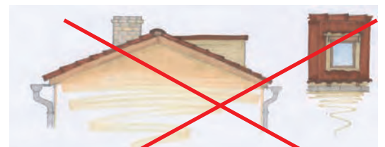
Ouvertures non intégrées à la pente du toit
