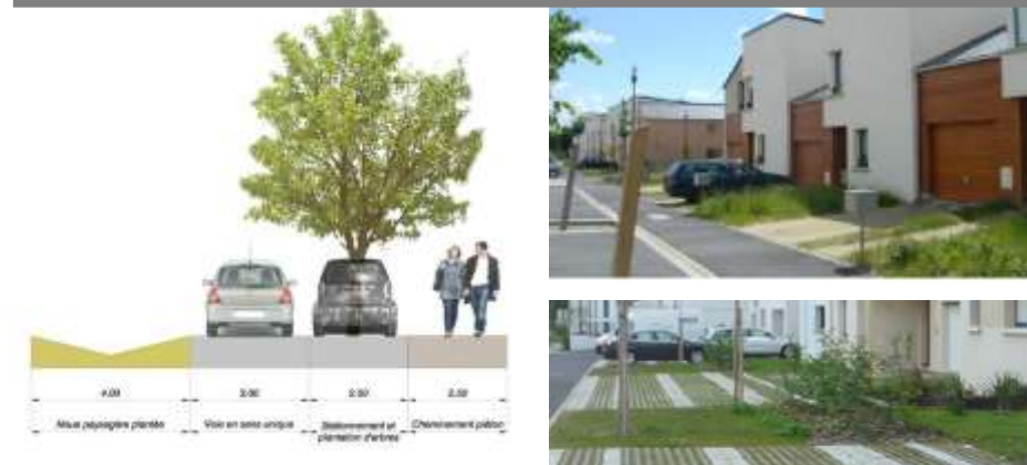
Exemples de traitement des eaux pluviales sous forme de noue ou de
