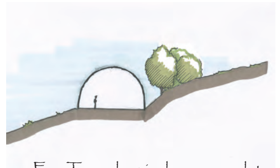
Ex: Tunnel agricole sur une plate-forme en déblai, adossé à une haie plantée
