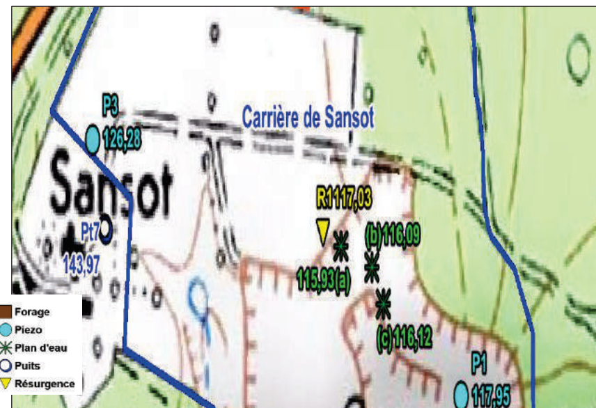
Niveaux piézométriques au sein de la carrière au 16/06/2014 (cote en m NGF)
