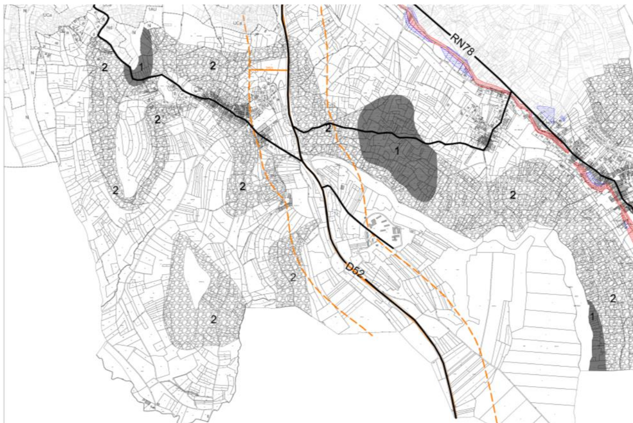
Carte de synthèse des risques mouvements de terrains (trame 1, 2, 3), zones de bruits par rapport à la RD52, et PPRI de la Vallière.
