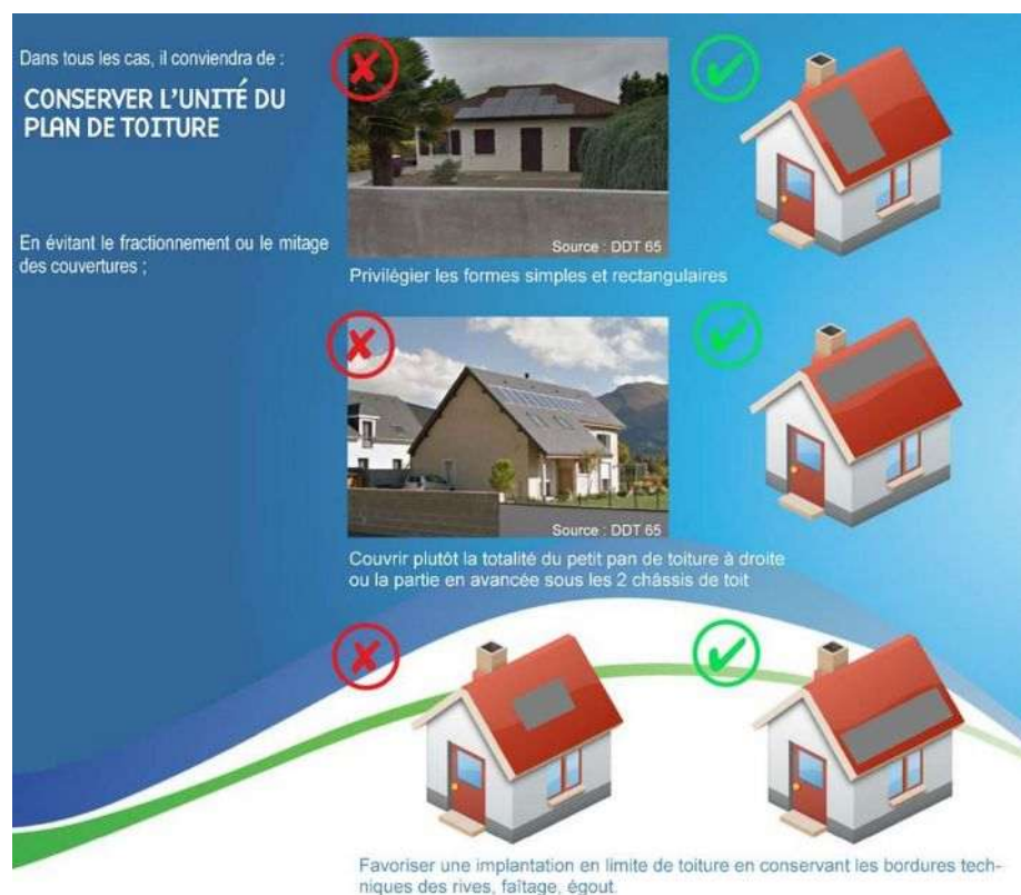
Figure 67. Bonnes et mauvaises intégrations des panneaux photovoltaïques ou thermiques en toiture
