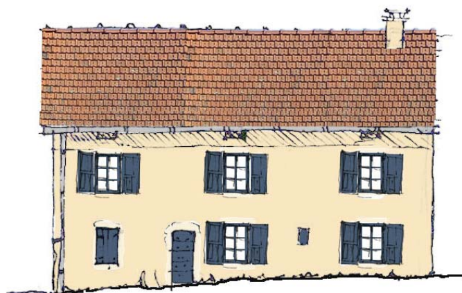
▲ Enduit de parement à la chaux Volets, porte et fenêtres : RAL 5007 ou 5024 aspect mat
