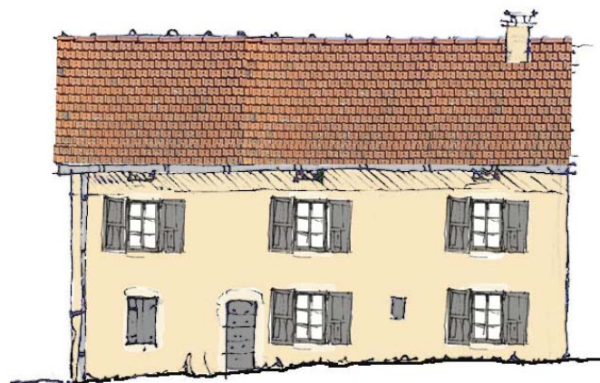
▲ Enduit de parement à la chaux Volets, porte et fenêtres : RAL 7045 aspect mat
