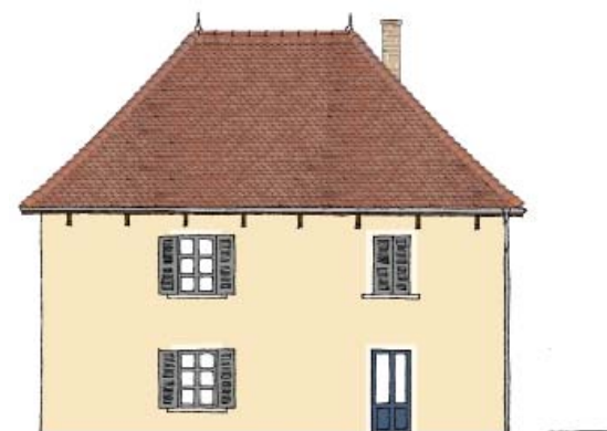
▲ Enduit de parement à la chaux Volets et fenêtres : RAL 7045 aspect mat Porte d'entrée : RAL 5007
