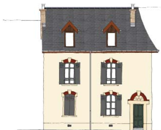
▲ Enduit de parement à la chaux Modénature en brique rouge à préserver ou reconstituer Volets et fenêtres : RAL 7046 aspect mat Porte : RAL 6003
