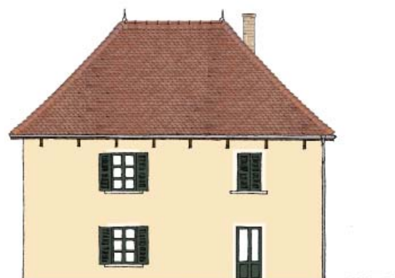
▲ Enduit de parement à la chaux Volets, porte et fenêtres : RAL 6003 ou 6013 aspect mat
