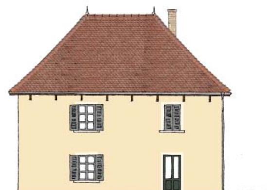
▲ Enduit de parement à la chaux Volets et fenêtres : RAL 7045 aspect mat Porte d'entrée : RAL 6003
