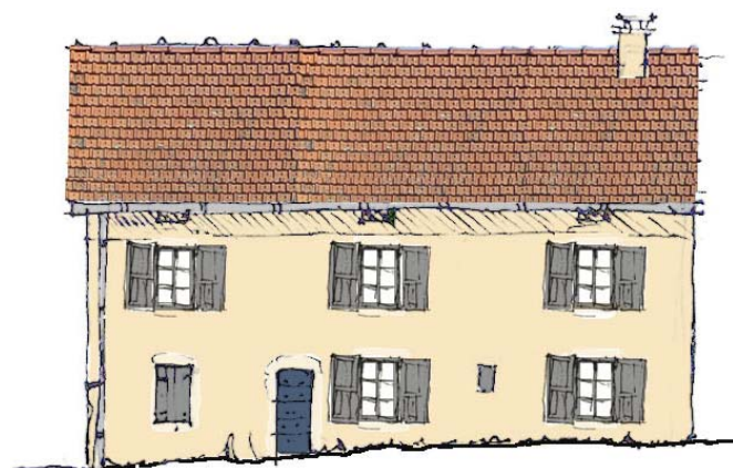
▲ Enduit de parement à la chaux Volets et fenêtres : RAL 7045 aspect mat Porte d'entrée : RAL 5007
