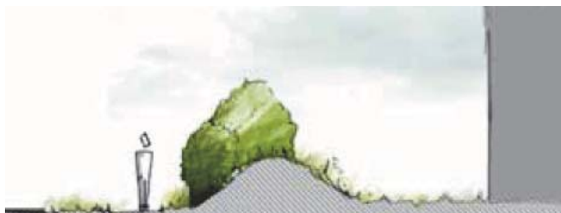
Clôture de type merlon planté
