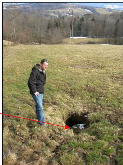
Figure 7 : Exemple de phénomène de suffosion (Commune de Cruseilles, Haute-Savoie 74).
