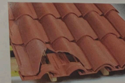
Pose du closoir d'égout, fixé par la tuile du 1er rang, par crochet V2 Réf. CRV02. (Le liteau ou le bandeau d'égout n'est plus relevé pour éviter le basculement du 1er rang de tuiles).
