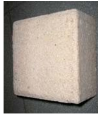
Pavés en béton poreux
