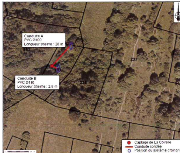
Figure 13 : photo aérienne présentant l'emplacement du captage de La Coirelle et les deux drains (source : inspection caméra Géotechnique)
